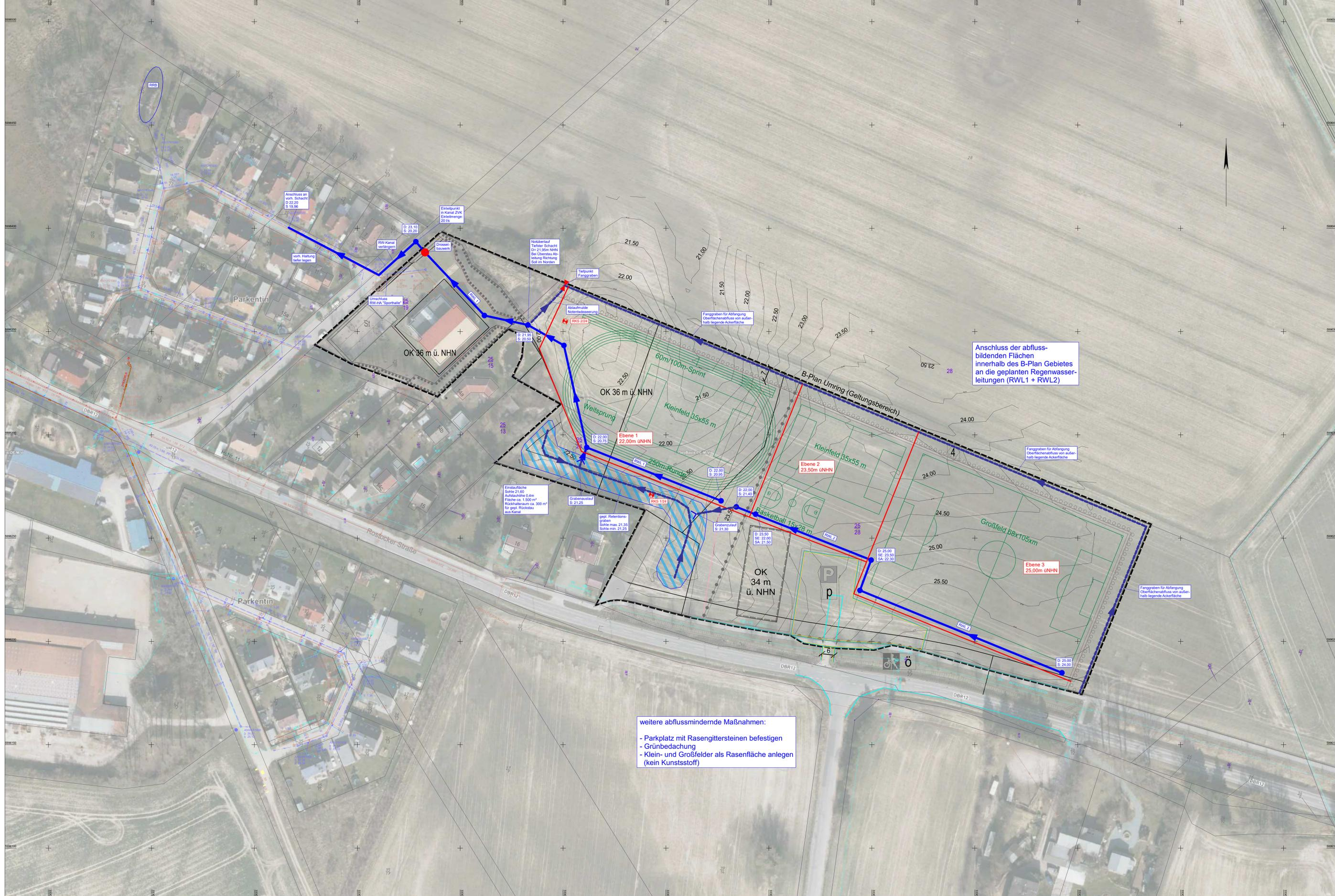
Anschluss der abflussbildenden Flächen innerhalb des B-Plan Gebietes an die geplanten Regenwasserleitungen (RWL1 + RWL2)
